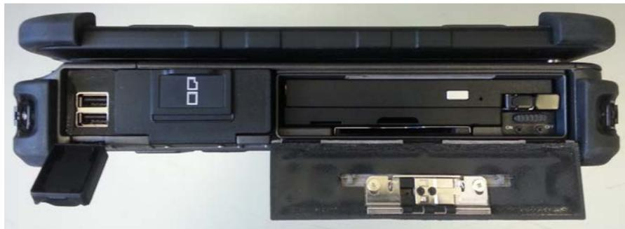
Рисунок Д.2 Левая боковая панель МВК-2(USB-разъемы и DVD-привод)
