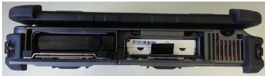
Рисунок Д.3 Правая боковая панель МВК-2 (аккумулятор и HDD накопитель)
