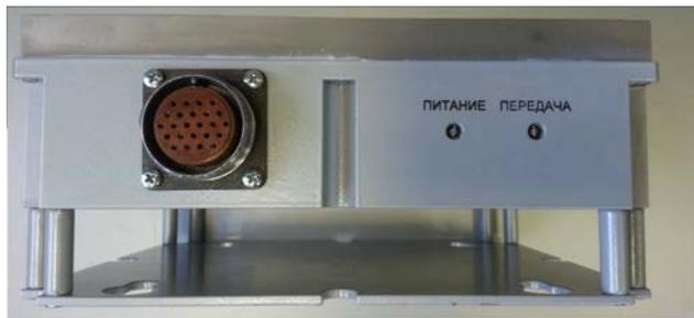
Рисунок Б.2 БАО-05 – нижняя боковая панель
