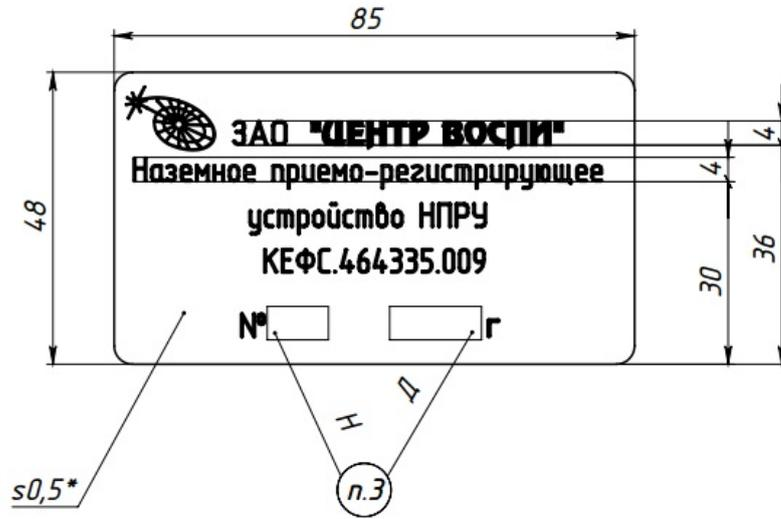
Рисунок И.1 Внешний вид шильда НПРУ
