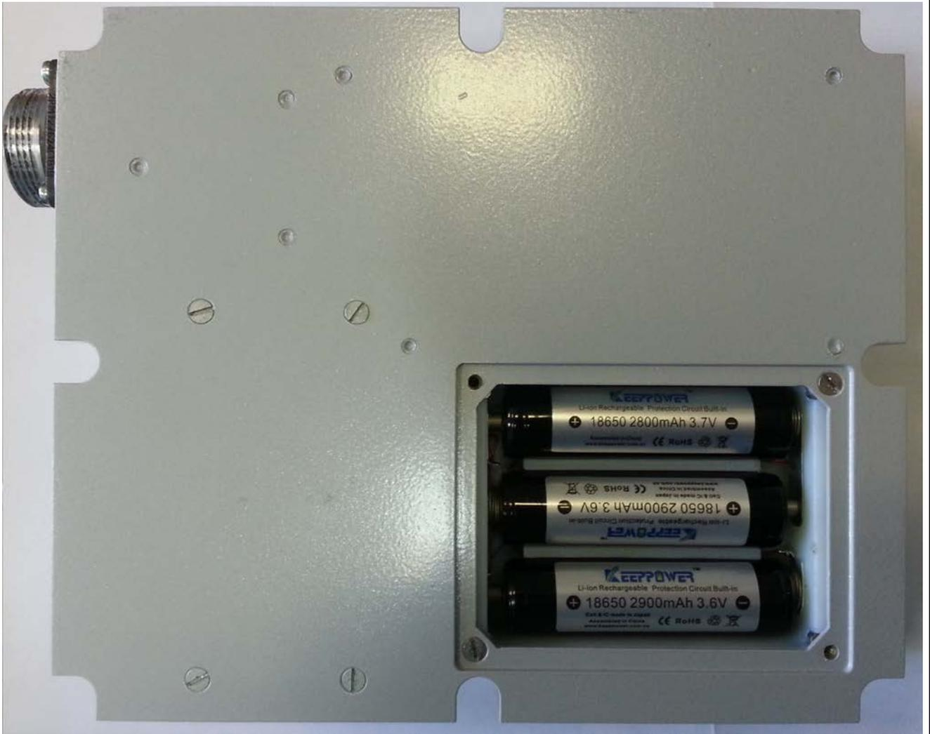
Рисунок В.5 БОС-05 – нижняя панель с аккумуляторным отсеком без крышки
