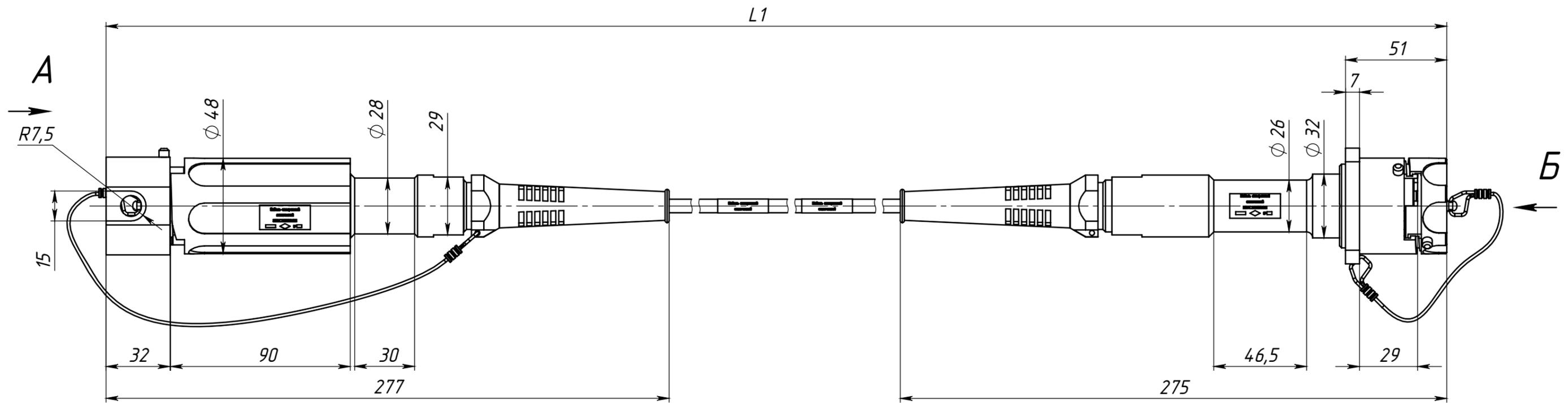
Рекомендуемый размер установочного отверстия для блочно-кабельного полуразъема СО-156-4-БК
